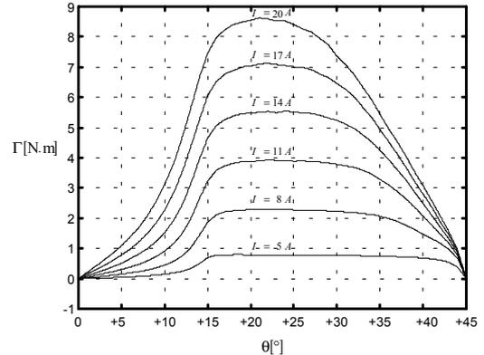
Fig. 4. Phase torque,  $\Gamma(\theta, I)$ .
