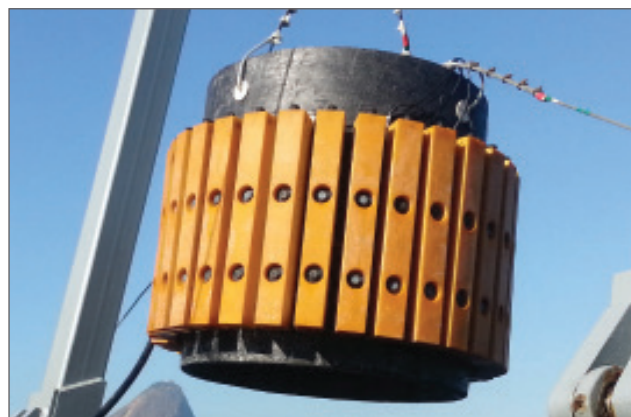
Figura 2. Arranjo de sensores de 32 staves .
