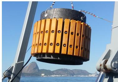
Figura 5: Arranjo Cilíndrico de Hidrofones.
