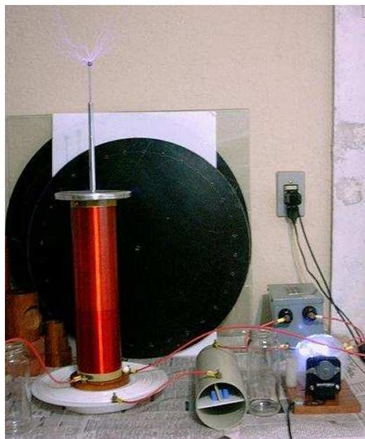
Vou descrever aqui uma bobina de Tesla que construí há algum tempo. Ela tem a característica não usual de ter sua sintonia feita pelo ajuste da capacitância do terminal, ao contrário do mais usual que é a sintonia pela variação da indutância da bobina primária. Foi tudo calculado precisamente, e o sistema funcionou como previsto. Tenho também algumas em inglês, que descrevem essa bobina e outras variações, a partir de:
