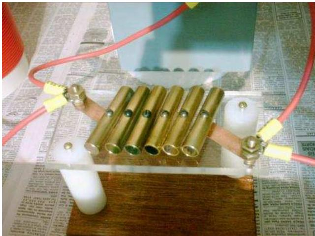
O faiscador (spark gap) é formado por 6 tubos de latão de 9 mm, presos com parafusos a uma base de acrílico. Os contatos externos são ligados aos tubos das extremidades por tiras de folha de cobre. Os tubos podem ser girados, permitindo ajuste da tensão de disparo do faiscador, que é normalmente de ~5000 V. A placa com os tubos é suportada por isoladores de nylon sobre uma base de madeira. Um ventilador alimentado pela rede sopra sobre o faiscador, mantendo-o frio.
