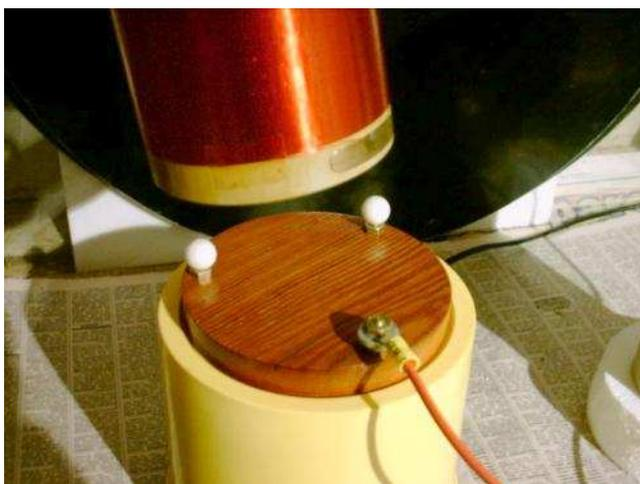
Para suportar a bobina secundária, foi feita uma base da madeira com um terminal que fica pressionado através de uma arruela contra o terminal inferior, e com duas bolinhas plásticas pressionando pelo outro lado. A bobina fica encaixada firmemente nessa base, mas pode ser facilmente colocada ou removida com uma torção.
